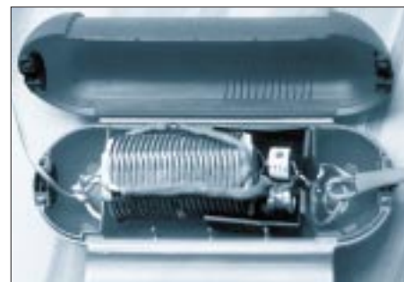
Bild 3: So läßt sich ein W3DZZ-Sperrkreis in die Safe-EI-Box einbauen.
