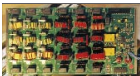
Bild 6: Der optional erhältliche Antennentuner ist nicht abgeschirmt und wird per Fuzzy-Logik abgestimmt.
