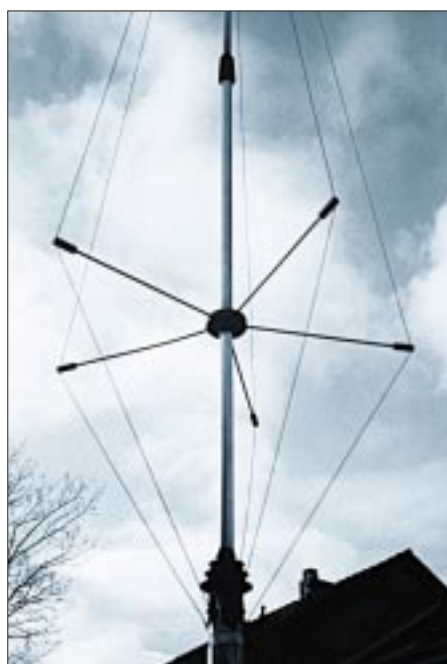
Bild 7: Die Seitendrähte sind beweglich gefertigt.
