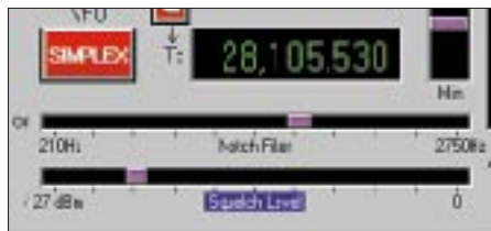
Bild 10: Die Funktionen der unteren Schieberegler werden dem jeweiligen Zweck angepasst. Hier dienen sie der Einstellung von Notchfrequenz und Rauschsperrschwelle.
