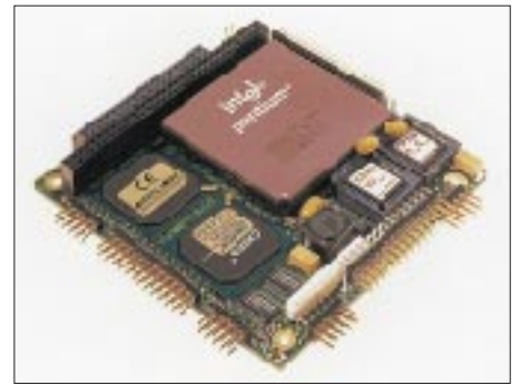
Bild 8: Der wohl kleinste Pentium-Rechner im PC/104-Format wurde um weitere Features ergänzt: Auf einer Fläche von 90 mm x 96 mm ist der gesamte Pentium-PC mit allen Schnittstellen, dem Videochip und neu mit bis zu 64 MB DRAM und einem 3,3-V-Schaltregler untergebracht. Foto: Digital-Logic AG
