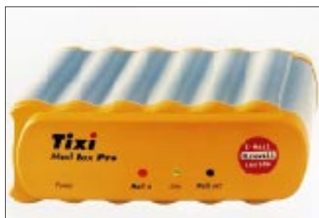
Bild 2: Die Tixi-Mail Box beherrscht die Internet-Kommunikation ebenso wie die direkte, schnelle und sichere Datenübertragung per Telefonleitung und ist überdies ein vollwertiger Faxspeicher.
