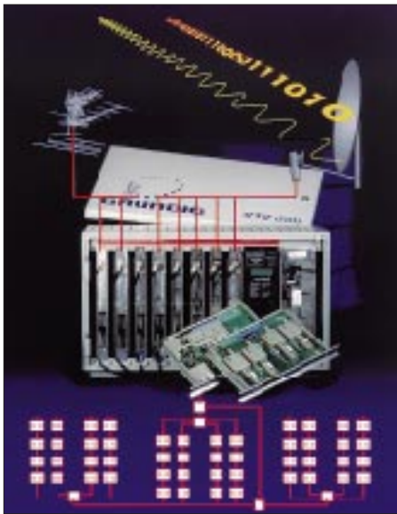
Bild 4: Grundig hat ein umfangreiches Angebot für Satellitenempfang im Produktprogramm, wie z.B. die Kopfstation STC 880, in der jetzt zwei statt nur einem Sat-Programm pro Kassette aufbereitet werden können.
