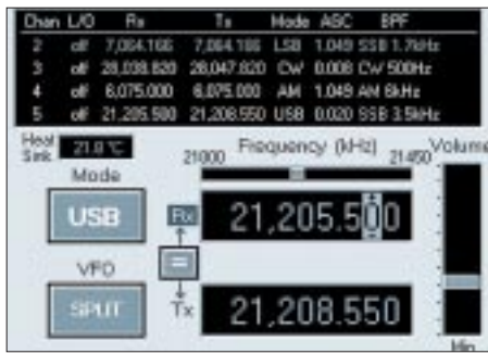
Bild 16: Der Speicher mit 100 Plätzen merkt sich wirklich alle Einstellungen, obwohl im eingeblendeten Menü nur die wichtigsten erscheinen.
